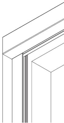
Optionale seitliche Führungsschienen SG 11542 zur Verwendung mit Fascia oder Box.
